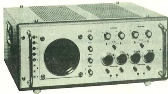
Bild 7 Zweistrahloszillograph OMS 811
