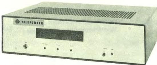
Bild 8 Digitalvoltmeter DVM 740
